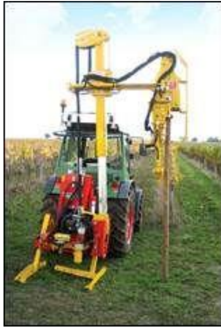
Figure 27 : Matériel de forage pour la pose des pieux
