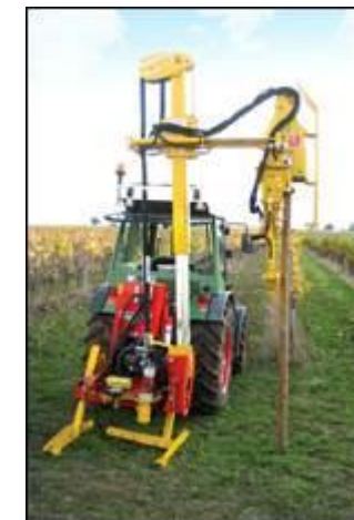
Photo 2 : Exemple d'enfonce-pieux (Source : Total Quadran – Rabaud SARL)
