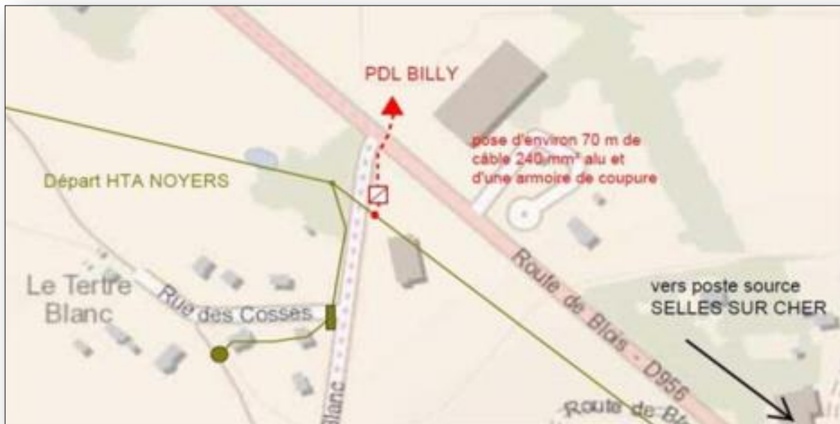
Hypothèse de modalités de raccordement au poste source (Source : ENEDIS)
