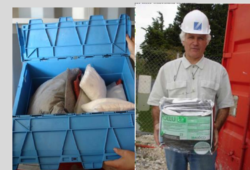
Photo 72 : Tri des déchets et produits absorbants et barrages à hydrocarbures stockés dans les containers sur les installations
