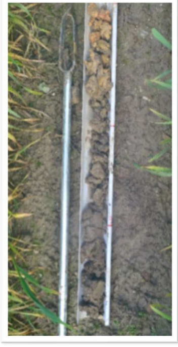
Photographie 2 : Exemple de carottage sur une profondeur de 120 cm
