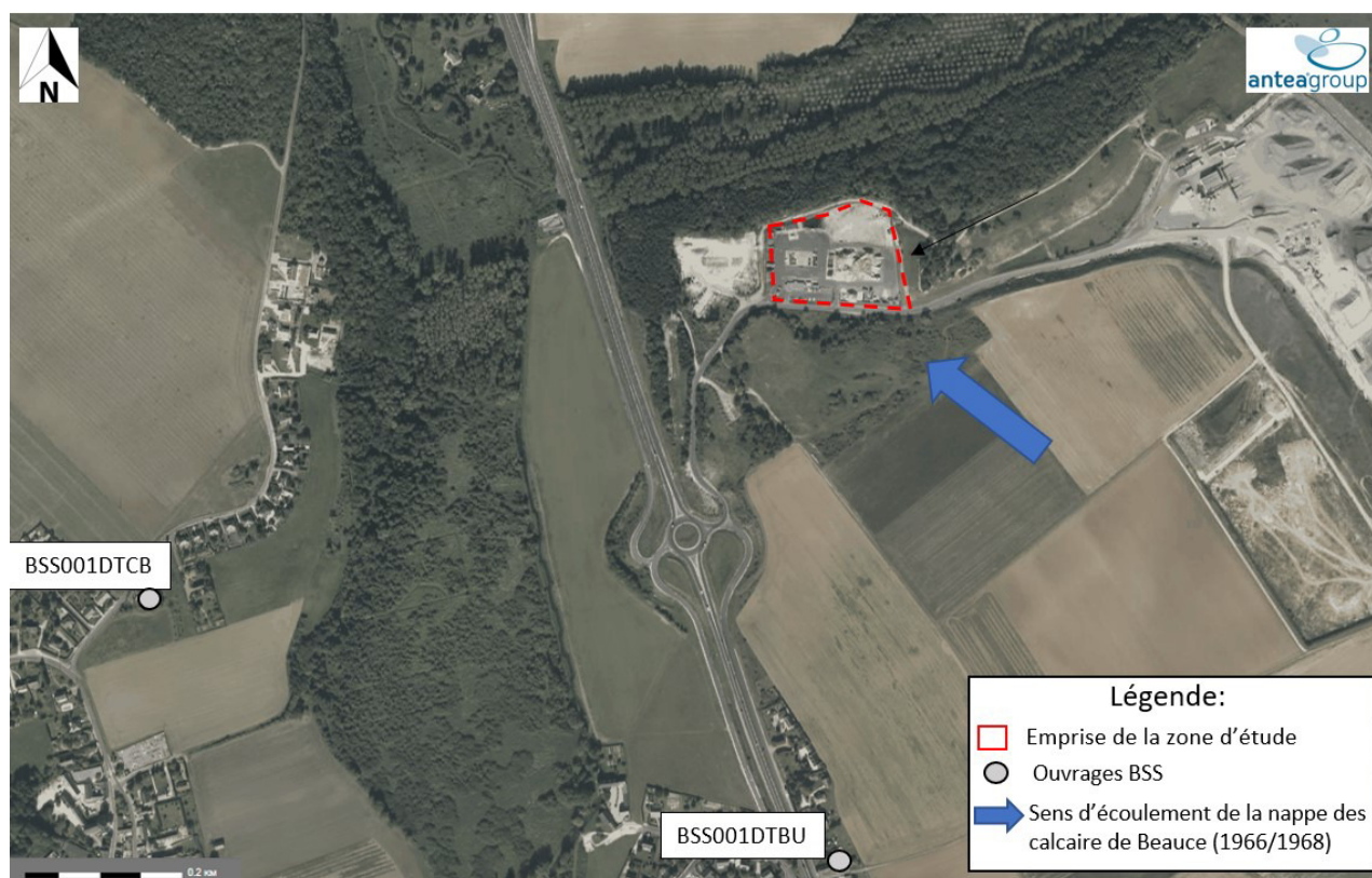
Figure 12 : Cartographie des ouvrages BSS et sens d’écoulement de la nappe au droit et à proximité du site
