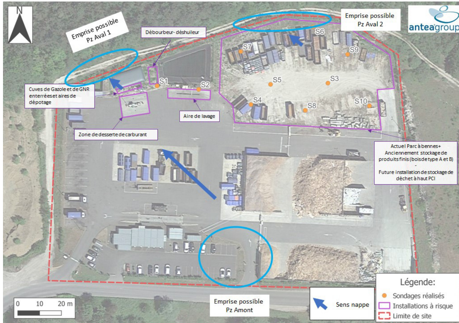
Figure 20 : Proposition d'implantation de piézomètres
