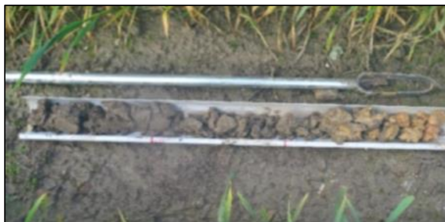
Illustration 60 : Exemple de carottage sur une profondeur de 120 cm
