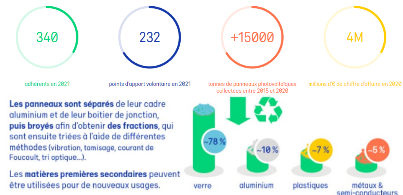
Figure 90 : Le traitement des panneaux photovoltaïques (source : Soren, 2022)
