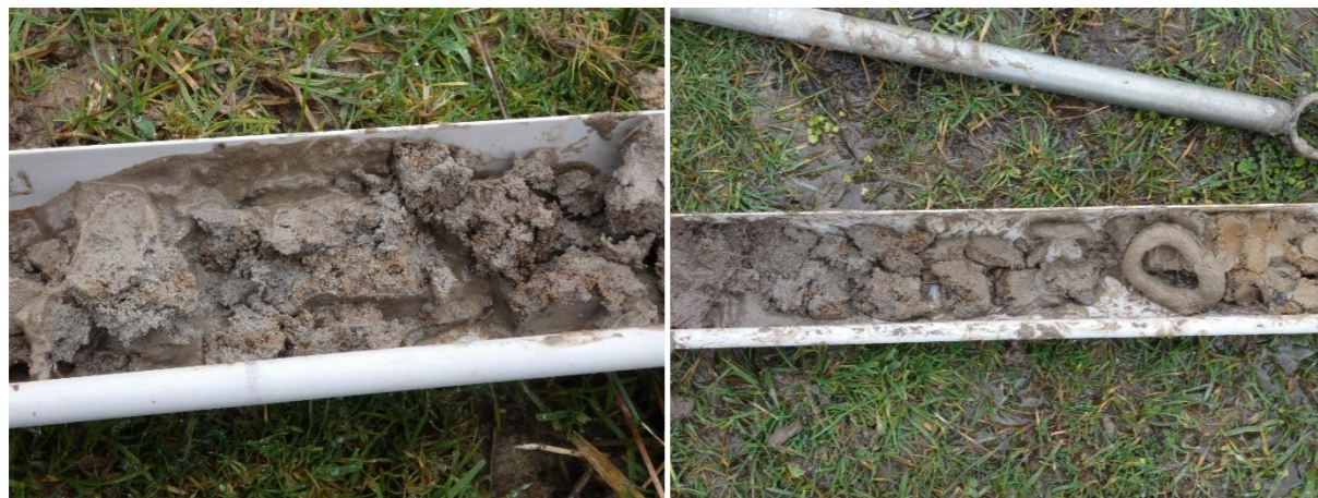
Photo 17 : Résultats de sondages pédologiques humides (avec traces rédoxiques) sur le site d'étude
