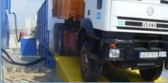
Plateforme de nettoyage et vidange mobile
