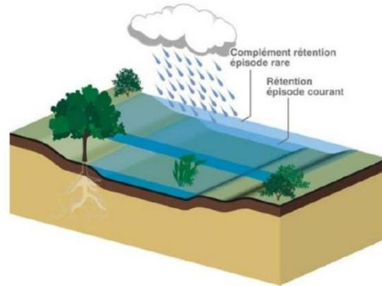
Figure 18: Noue à stockage superposé : les eaux d'évènements pluviaux courants sont stockées dans un volume au fond de la noue (pluie annuelle par exemple), tandis que les suppléments d'eaux dus à des évènements plus rares sont stockés dans la partie supérieure par débordement du premier niveau (pour les pluies décennales ou centennales par exemple).
