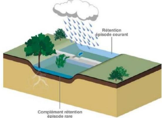
Figure 19: Noue à stockage successif : les eaux d'évènements pluviaux courants sont stockées dans un premier tronçon en amont (pluie annuelle par exemple), tandis que le supplément d'eau dû à des évènements plus rares est stocké dans un tronçon successif par un dispositif de surverse (pour les pluies décennales ou centennales par exemple).
