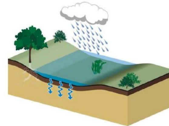
Figure 10: Noue engazonnée et plantée infiltrante.
