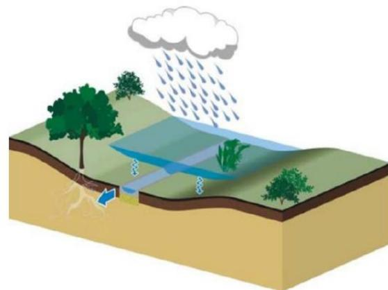
Figure 12: Noue infiltrante à cunette en son creux pour écouler les petits épisodes pluvieux et le début et/ou la fin des épisodes plus rares afin d'éviter les flaques
