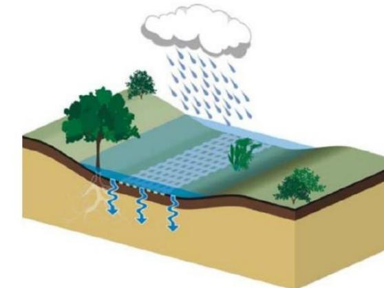
Figure 11: Noue engazonnée infiltrante renforcée dans son fond
