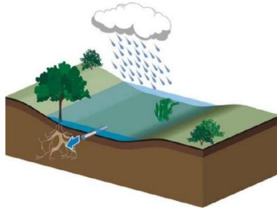
Figure 6 : Noue à évacuation superficielle. Le sol est très peu perméable. Les eaux stockées sont évacuées à débit régulier vers un exutoire via un orifice au pied de la noue. Cet orifice doit être très régulièrement entretenu pour éviter toute obstruction.
