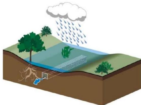
Figure 15: Noue drainante sur un sol très peu perméable. Les eaux stockées dans la noue s'infiltrent dans le substrat superficiel et sont drainées dans un massif qui évacue les eaux à débit régulé vers un exutoire.
