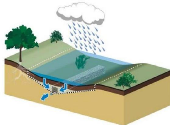
Figure 16: Noue drainante à fond imperméabilisé par une géomembrane. Les eaux percolent via le substrat superficiel vers un large massif drainant et sont évacuées à débit régulé vers un exutoire.
