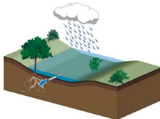
Figure 14 : Noue à évacuation superficielle. Le sol est très peu perméable. Les eaux stockées sont évacuées à débit régulé vers un exutoire via un orifice au pied de la noue. Cet orifice doit être très régulièrement entretenu pour éviter toute obstruction.
