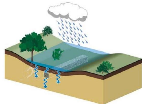
Figure 13: Noue infiltrante avec enrochement linéaire en son point bas afin de limiter l'apparition de flaque. Ce massif n'est pas drainé par une évacuation vers un exutoire mais permet de stocker temporairement une partie des eaux de ruissellement.
