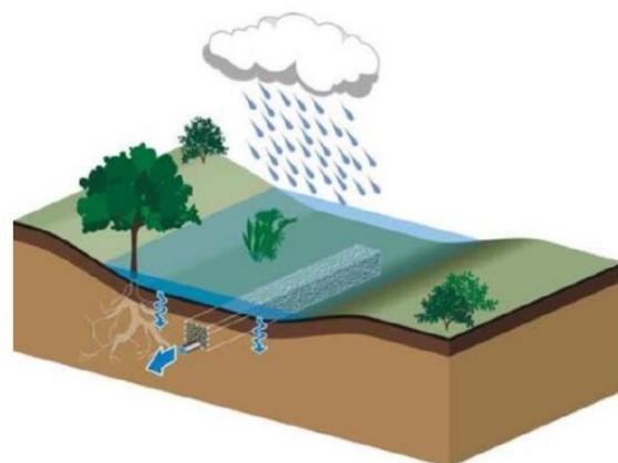
Figure 17: Noue mixte, à la fois infiltrante et drainante, sur un sol moyennement perméable
