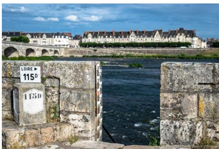
Vous trouverez plusieurs échelles limnimétriques en bord de Loire. Elles permettent de mesurer le niveau du fleuve.
