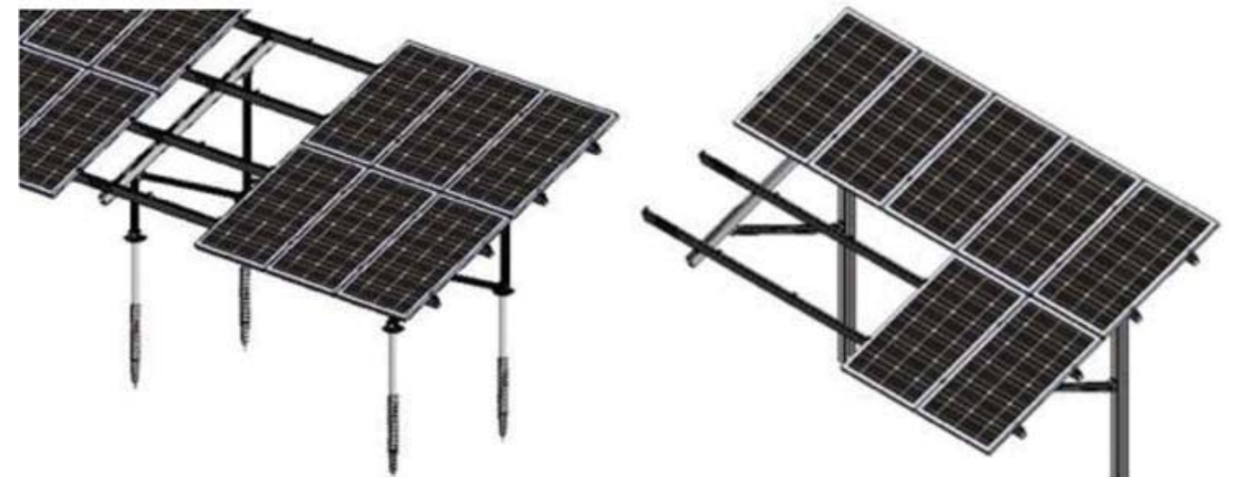
Figure 22 : Système de vis (à gauche) ou système de pieux battus (à droite) pour la structure des panneaux solaires
