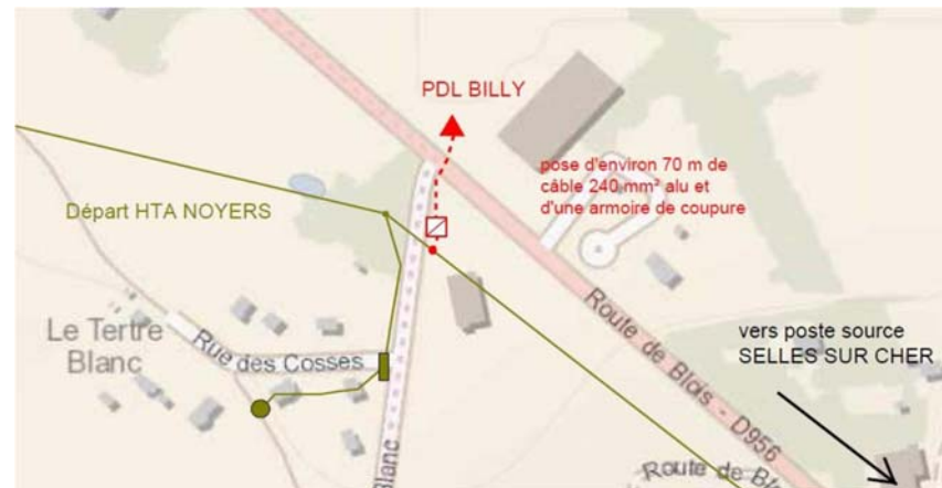
Figure 8 : Hypothèse de modalités de raccordement au poste source (Source : ENEDIS)
