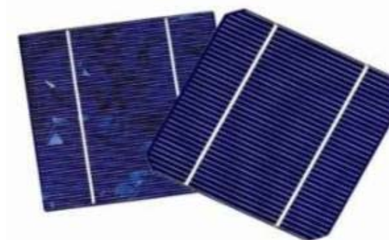
Figure 4: Cellules en silicium polycristallin (gauche) et monocristallin (droite)
