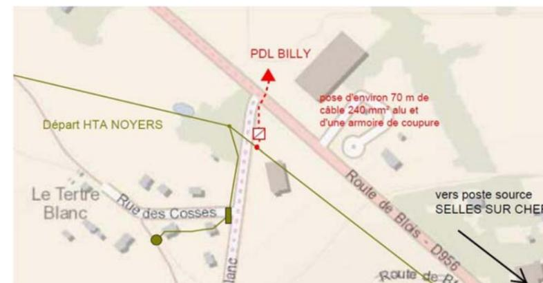
Figure 43 : Hypothèse de modalités de raccordement au poste source
