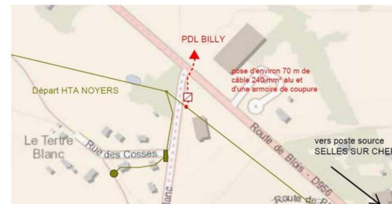
Figure 10 : Hypothèse de modalités de raccordement au poste source
