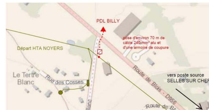
Figure 42 : Hypothèse de modalités de raccordement au poste source (Source : ENEDIS)
