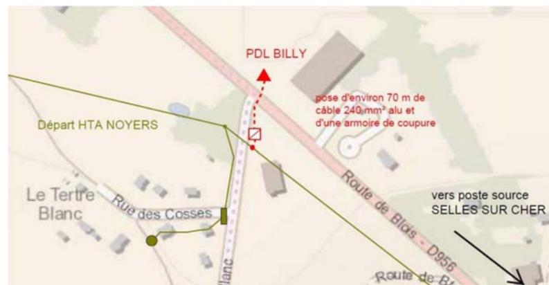
Figure 6 : Hypothèse de modalités de raccordement au poste source
